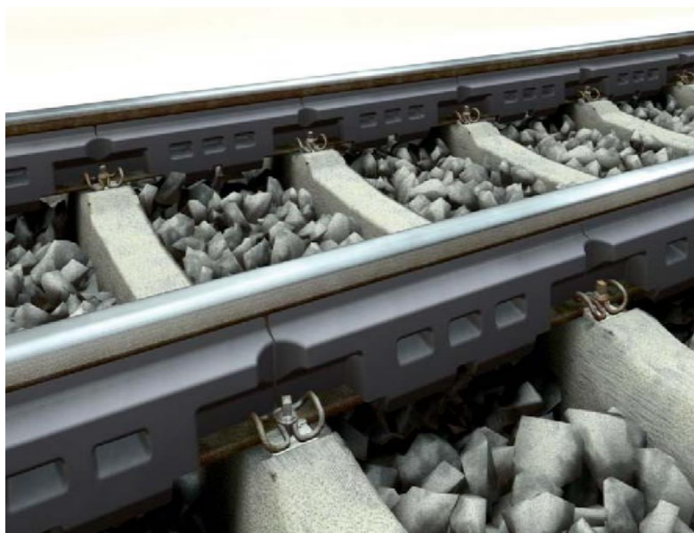
Рисунок 1.2 – Вибродемпфирующая резиновая накладка на шейку рельса
