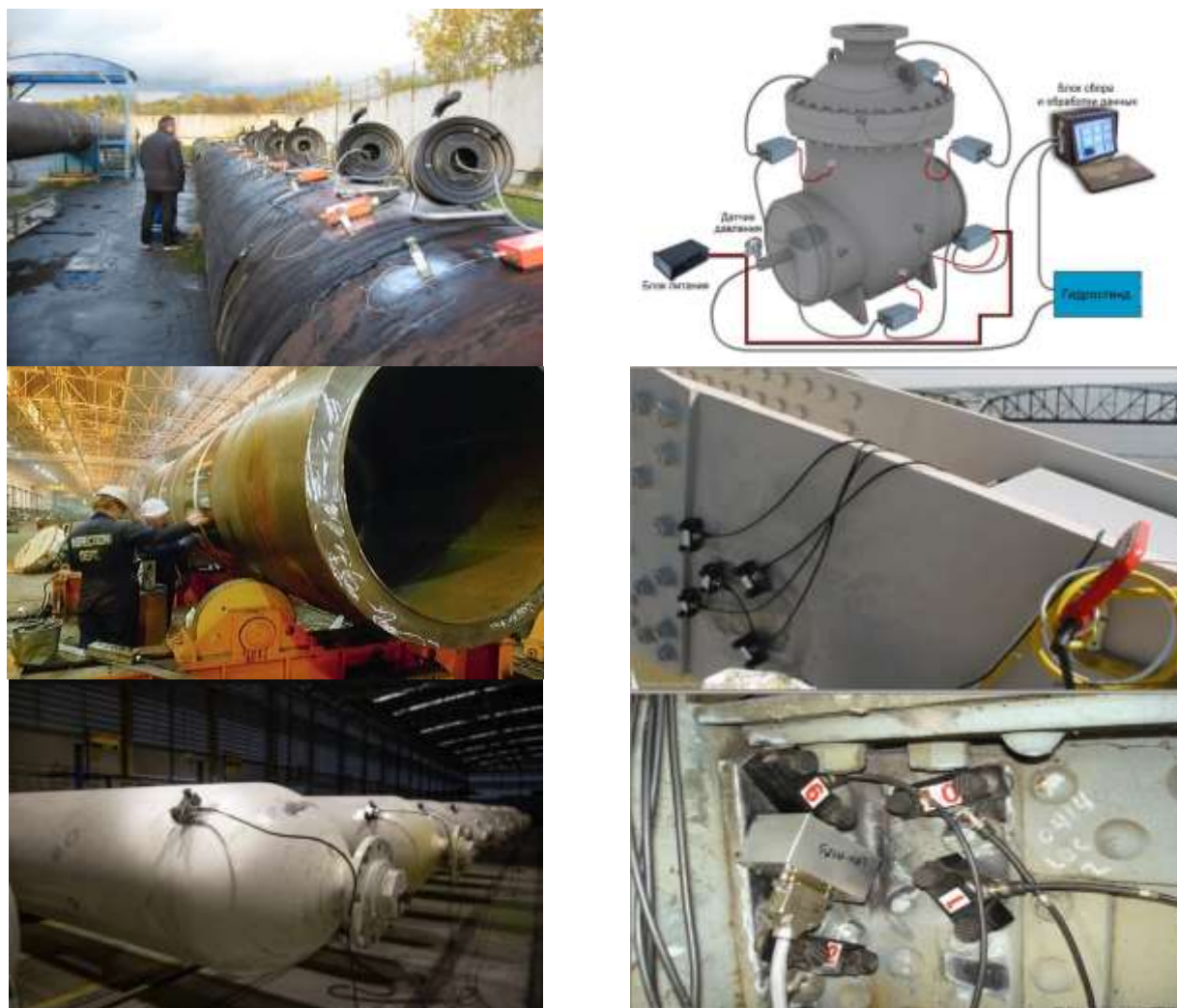
Рисунок 1.4 – Применение метода акустической эмиссии
