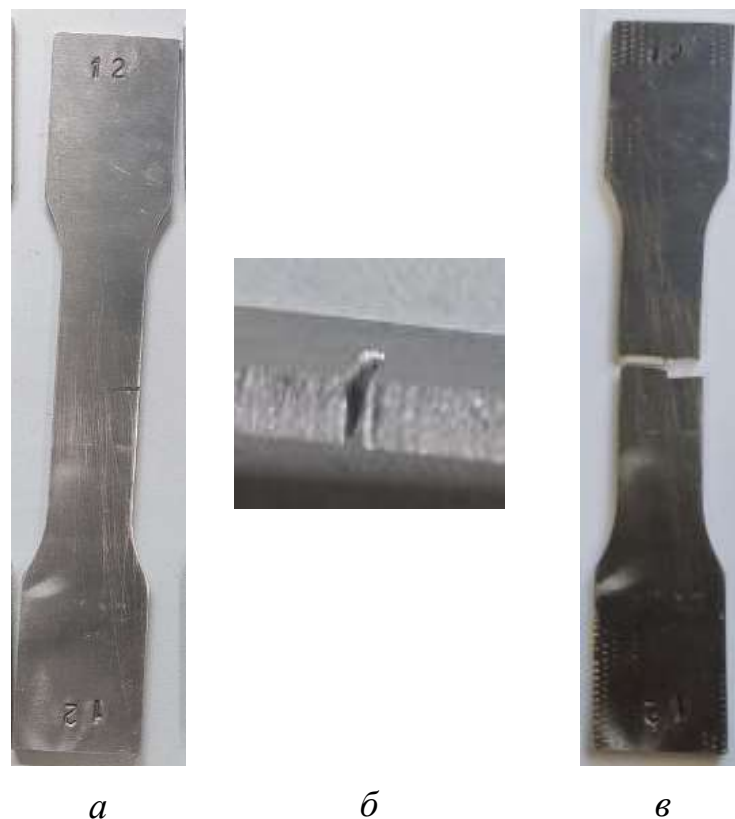
Рисунок 2.16 – Фотография образца для статических испытаний с предварительно нанесенной сквозной трещиной до и после испытаний: а – фотоснимок образца № 12 до испытания; б – укрупненный фотоснимок предварительно нанесенной трещины; в – фотоснимок образца № 12 после испытания
