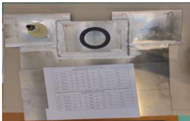
Рисунок 4.5 – Фотоснимок образца № 2 из АМгбНОП с нанесенными сквозными трещинами с установленной оснасткой
