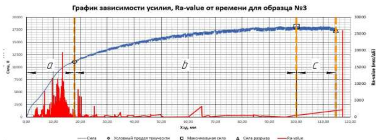
Рисунок 2.14 – График зависимости усилия, Ra-value от времени для алюминиевого цельного образца из АМГ6 при растяжении на испытательной машине SHIMADZU AG-X-1
