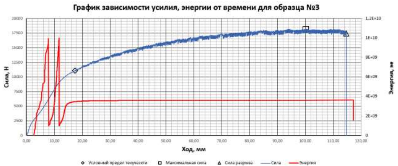
Рисунок 2.21 – Графики зависимости усилия, энергии от времени для образца с предварительно нанесенной трещиной № 12 (а) и цельного образца № 3 (б)
