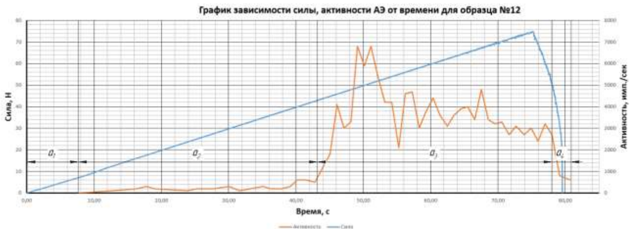
Рисунок 2.18 – График зависимости усилия, активности АЭ от времени для алюминиевого цельного образца из АМГ6 с предварительно нанесенной трещиной, полученный при растяжении на испытательной машине SHIMADZU AG-X-1
