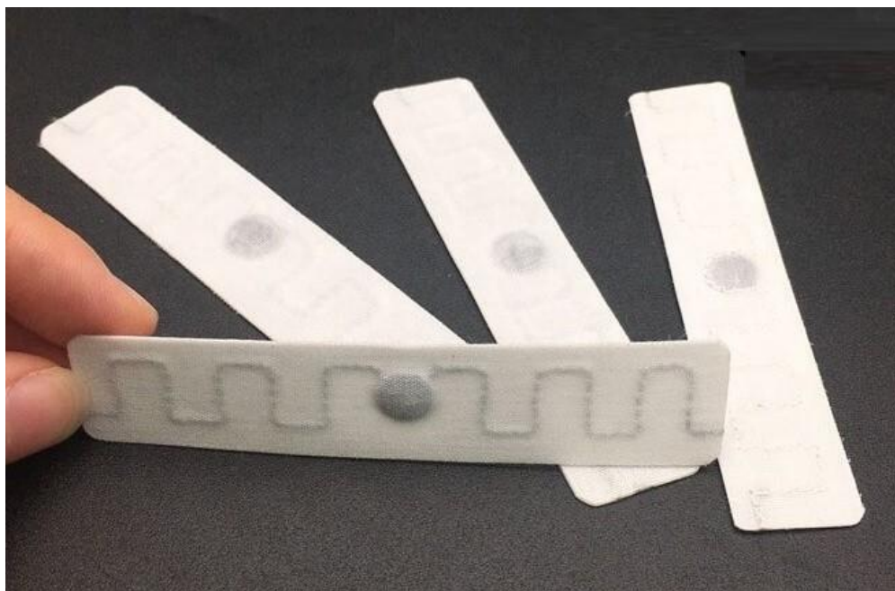
Рисунок 5.23 – Внешний вид пассивной RFID-метки
