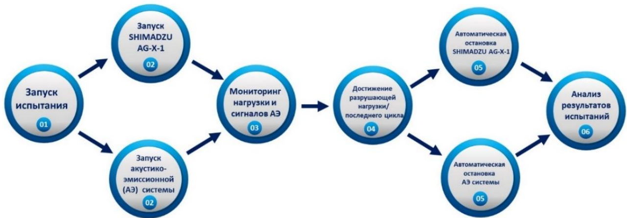
Рисунок 3 – Схема алгоритма для проведения экспериментов
