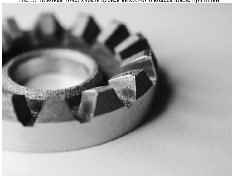
Рис. 6. Боковая поверхность зубьев сателлита после притирки
