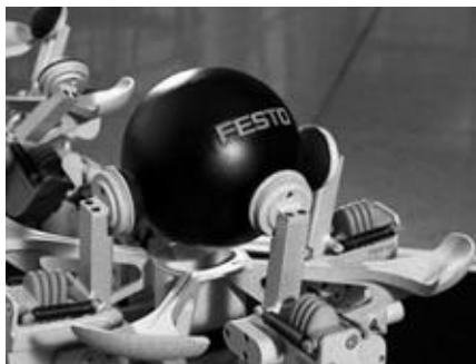
Рисунок 3—Самообучающийся захват LearningGripper
