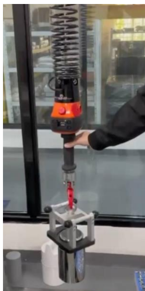
Рисунок 2 – Манипулятор для подъема грузов
