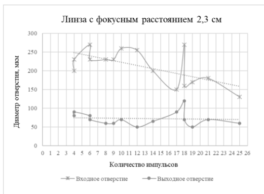
Рисунок 5 – График зависимости диаметра отверстия от количества импульсов для линзы с фокусным расстоянием 2,3 см
