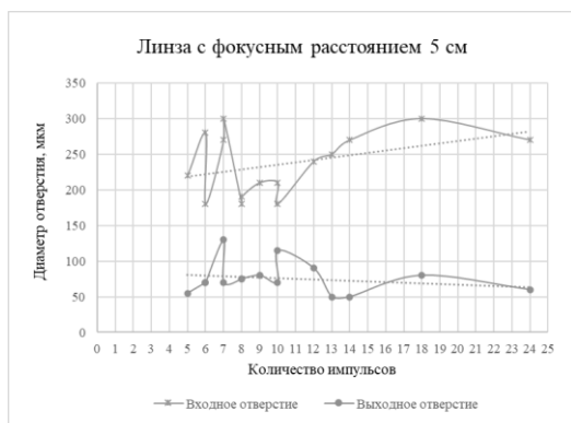
Рисунок 7 – График зависимости диаметра отверстия от количества импульсов для линзы с фокусным расстоянием 5 см
