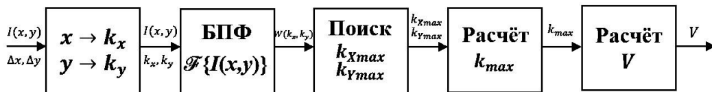
Рисунок 3 – Структурная схема алгоритма оценки скорости корабля по РЛИ КС
