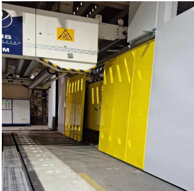
Рисунок 3. Примерный вид кожуха, который предлагается к установке
