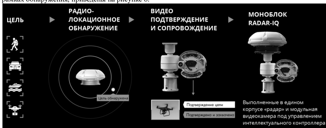
Рис. 6 – Система «Radar-IQ» и ее составляющие (с функционалом) [5]
