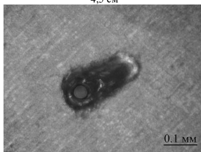
Рисунок 4 – Входное отверстие, сделанное с помощью линзы с фокусным расстоянием 9 см
