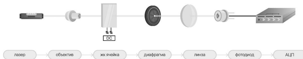
Рис. 1. Оптическая схема эксперимента
