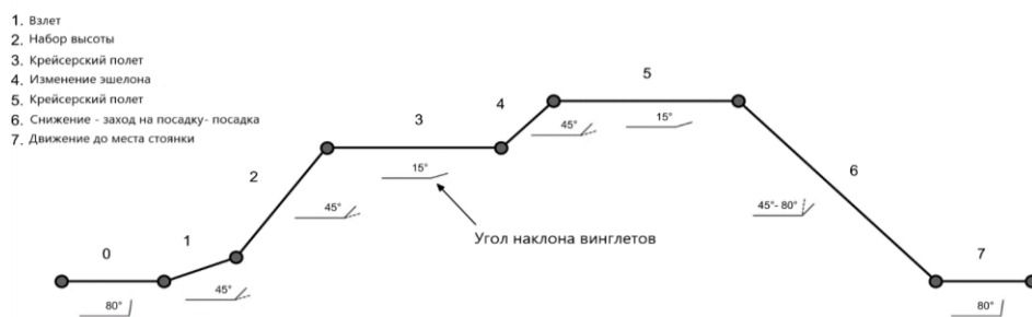
Рис.3. Рекомендации по настройке винглета на различных этапах полета.
