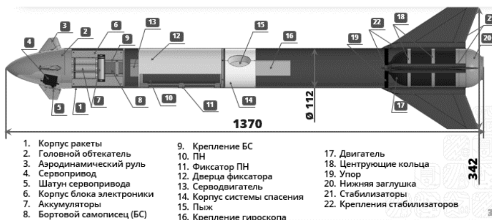
Рис. 1 – Схема ракеты-носителя с боковым отстрелом ПН в разрезе
