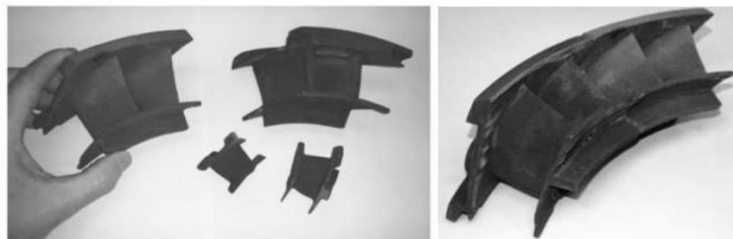
Рис. 3. Плазменное напыление карбида кремния с армирующими волокнами на лопатки соплового аппарата и сектор газотурбинного двигателя [4].
