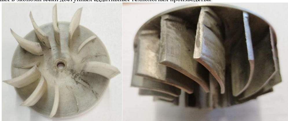
Рис.1. Фото не работоспособных роторов-активаторов: а) – ротор базовой конструкции из полистирола PS 6; б) – ротор базовой конструкции из сплава АМг6
