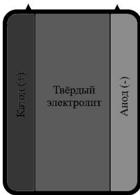
Рис. 2. Схематичное представление устройства твердотельного аккумулятора
