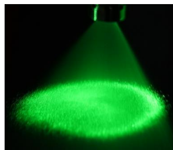
Рис. 4 Использование «лазерного ножа» для контроля равномерности распределения топлива
