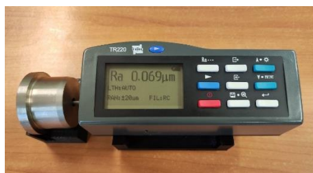
Рис. 4. Измерение шероховатости обработанной поверхности профилометром TIME TR220
