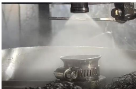
Рис. 3 Проливка топливной форсунки на испытательном стенде
