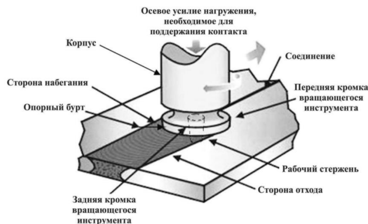
Рис.1. Схема сварки трением [1]
