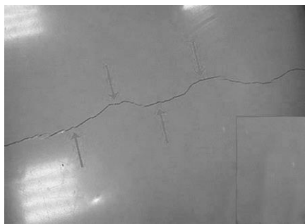
Рис.1. Трещина с простой геометрией в полиуретановом лакокрасочном покрытии
