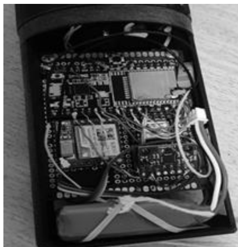
Рис. 3. Пример компоновки электронного модуля 80х64мм в головном обтекателе второй ступени.
