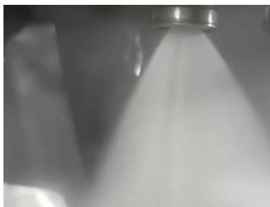
Рис. 9 – нарушение сплошности топливного факела, вызванное заусенцами в дозирующих пазах завихрителя
