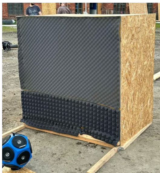
Рисунок 1.1 — Вид испытываемого АЭ в свободном звуковом поле
