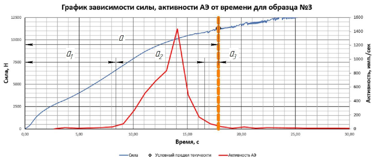
Рисунок 2.10 – Увеличенный участок упругопластической деформации графика зависимости усилия, активности АЭ от времени для алюминиевого цельного образца из АМГ6 при растяжении на испытательной машине SHIMADZU AG-X-1
