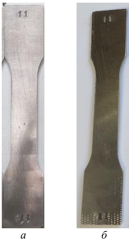
Рисунок 2.22 – Фотография цельного образца № 11 для циклических испытаний: а – фотоснимок образца № 11 до испытания; б – фотоснимок образца № 11 после испытания
