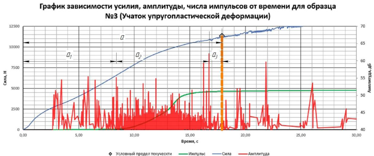
Рисунок 2.9 – Увеличенный участок упругопластической деформации графика зависимости усилия, амплитуды, импульса от времени для алюминиевого цельного образца из АМГ6 при растяжении на испытательной машине SHIMADZU AG-X-1
