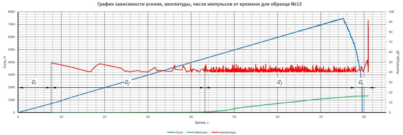
Рисунок 2.17 – График «усилие ( P ) – удлинение ( \Delta l )» для образца № 12
