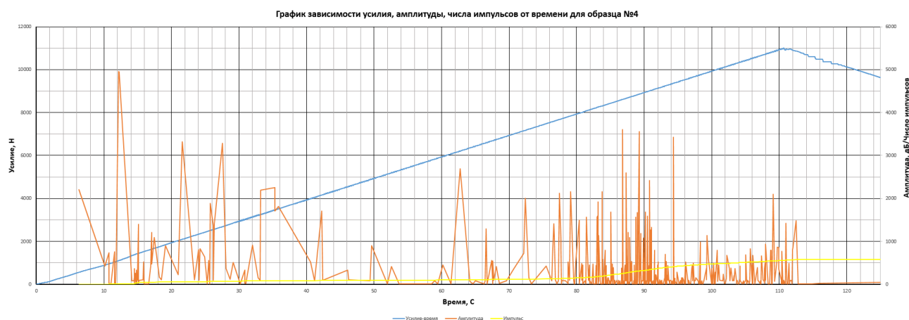
Рисунок 2.31 – Увеличенный участок графика 2.28 (график зависимости усилия, мощности от времени для алюминиевого образца № 4 с предварительно нанесенной несквозной трещиной из АМГ6 при циклическом нагружении на испытательной машине SHIMADZU AG-X-1)
