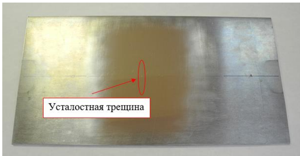
Рисунок 4.2 – Образец № 1 размером 178 \times 400 \times 3,5 из сплава АМгбНОП со сквозной усталостной трещиной
