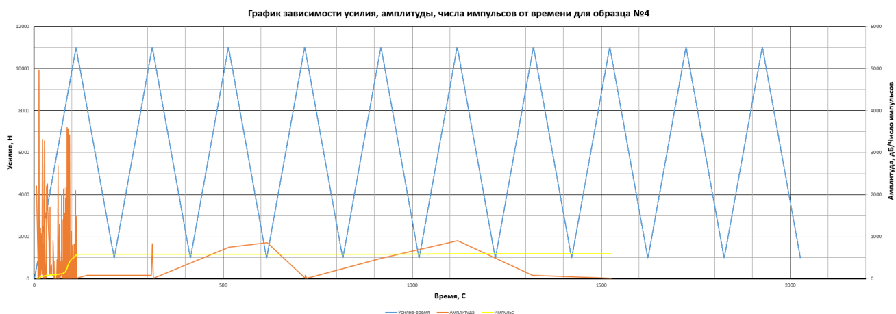
Рисунок 2.27 – Графики зависимости усилия, амплитуды, импульса от времени для алюминиевого образца № 4 с предварительно нанесенной несквозной трещиной из АМГб при циклическом нагружении на испытательной машине SHIMADZU AG-X-1
