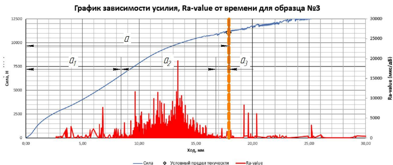
Рисунок 2.11 – Увеличенный участок упругопластической деформации графика зависимости усилия, Ra-value от времени для алюминиевого цельного образца из АМГ6 при растяжении на испытательной машине SHIMADZU AG-X-1
