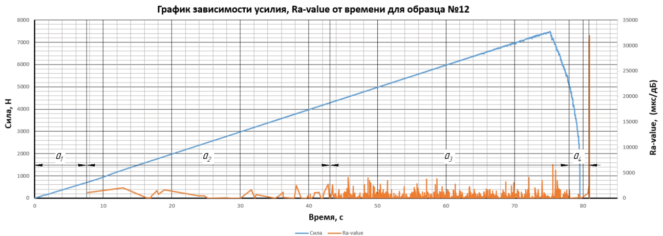
Рисунок 2.19 – График зависимости усилия, Ra-value от времени для алюминиевого цельного образца из АМГ6 с предварительно нанесенной трещиной, полученный при растяжении на испытательной машине SHIMADZU AG-X-1
