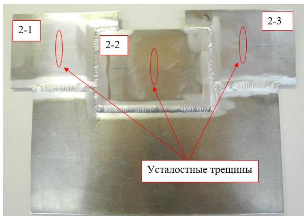
Рисунок 4.3 – Образец № 2 размером 278×400×3,5 из сплава АМгбНОП со сквозной усталостной трещиной
