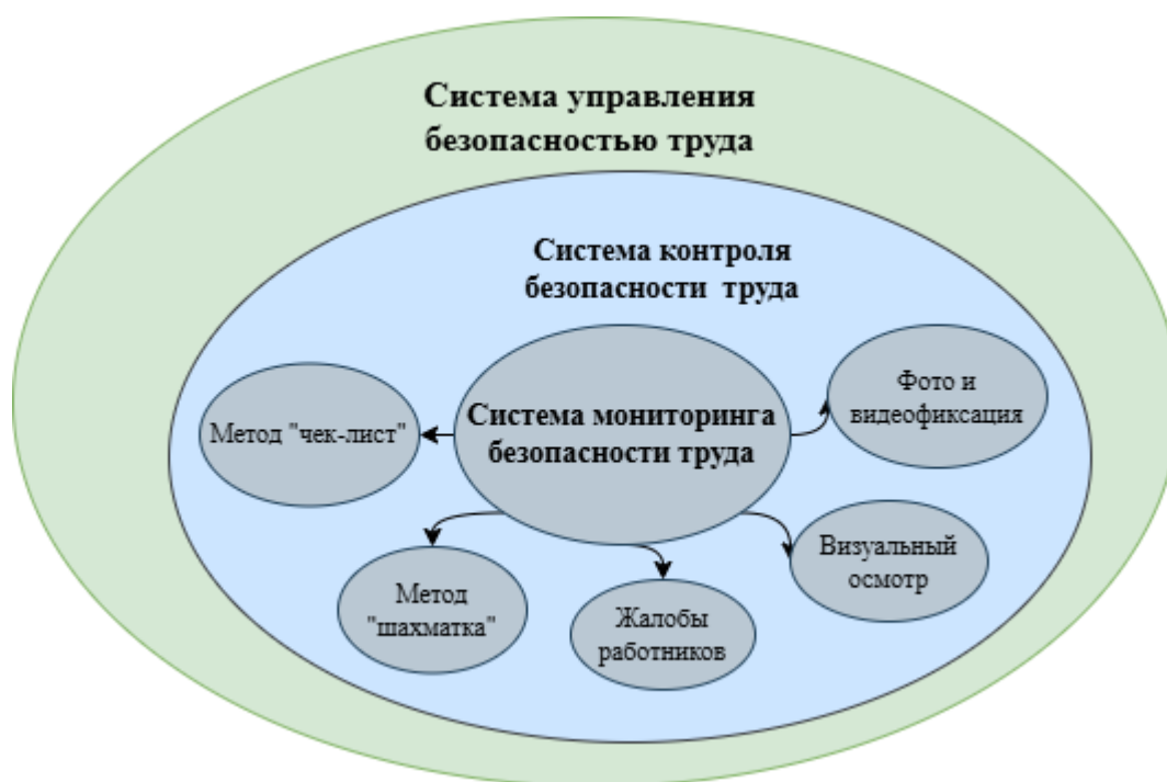
Рисунок 1.3 – Структура системы управления безопасностью труда
