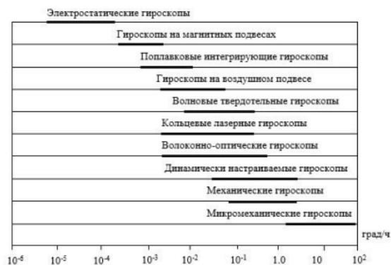
Рис. 1.17. Остаточная скорость ухода (в градусах в час) гироскопов различных типов
