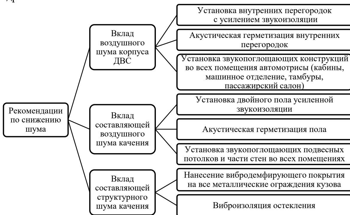
Рисунок 5 – Общая схема рекомендаций по снижению шума в помещениях автомотрисы
