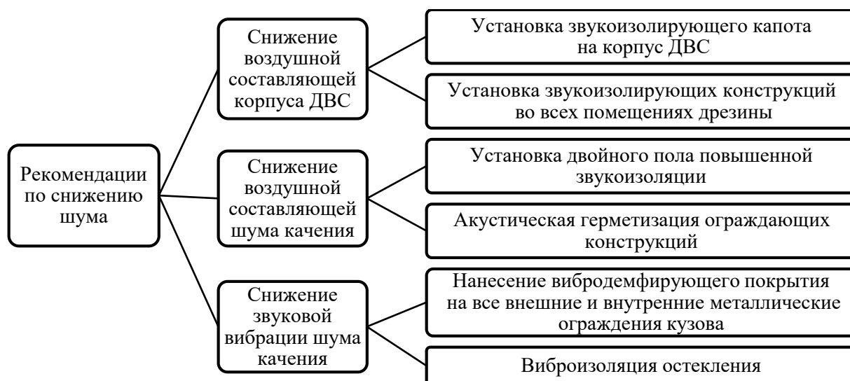
Рисунок 6 – Общая схема рекомендаций по снижению шума в помещениях автодрезин
