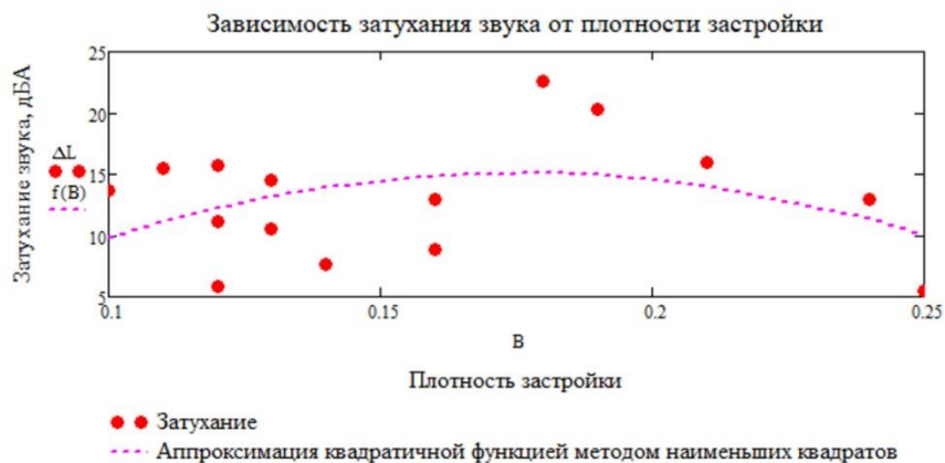
Рисунок 4 – График зависимости затухания звука в застройке ( \Delta L ) от ее плотности
