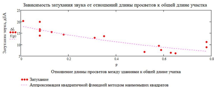
Рисунок 6 – График зависимости затухания звука в застройке ( \Delta L ) от отношения длин проветров между домами к общей длине участка
