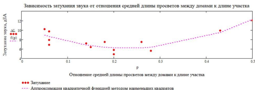
Рисунок 8 – График зависимости затухания звука в застройке ( \Delta L ) от отношения средней длины пролетов между домами к общей длине участка
