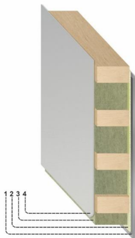
Рисунок 12 – Устройство многослойной звукоизолирующей перегородки вагона-электростанции:
