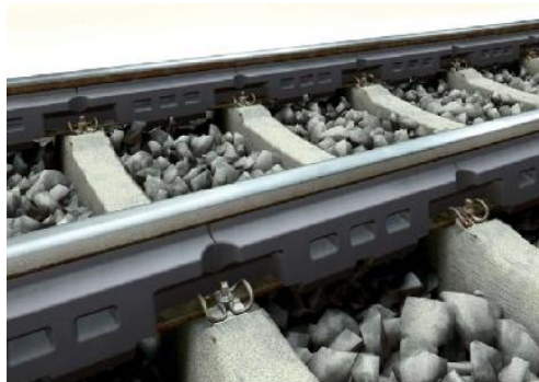
Рисунок 1.13 – Вибродемпфирующая резиновая накладка на шейку рельса
