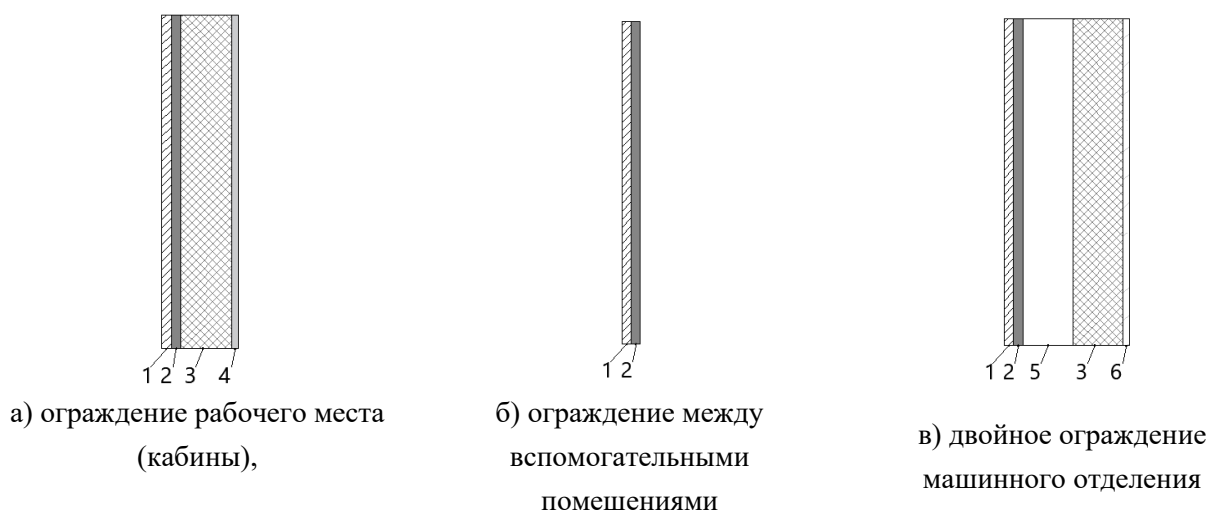
Рисунок 1.16 – Схемы звукоизоляции с наличием вибродемпфирующих конструкций:
