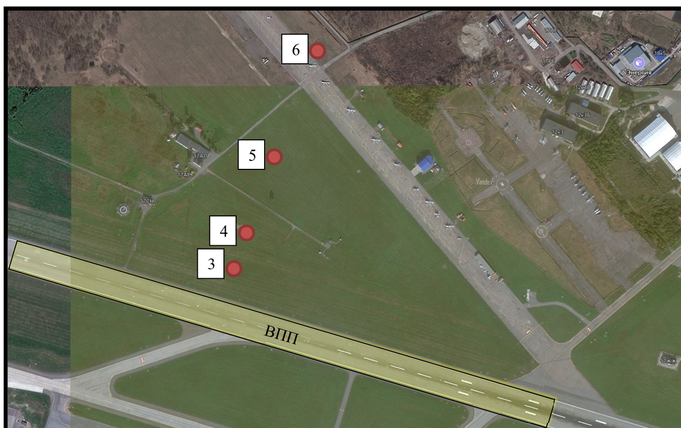
Рисунок 3.19 – Схема измерений уровней шума при удалении от ВПП (3,4,5,6 – точки измерений).
