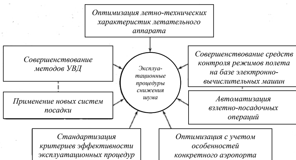
Рисунок 1.8 – Основные пути совершенствования эксплуатационных процедур снижения шума
