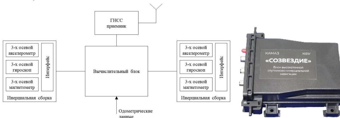
Рисунок 3 – Структурная схема и фотография системы «Созвездие»
