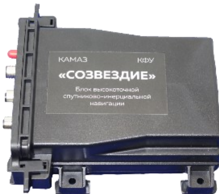
Рисунок 2.8 – Система высокоточной спутниково-инерциальной навигации «Созвездие»
