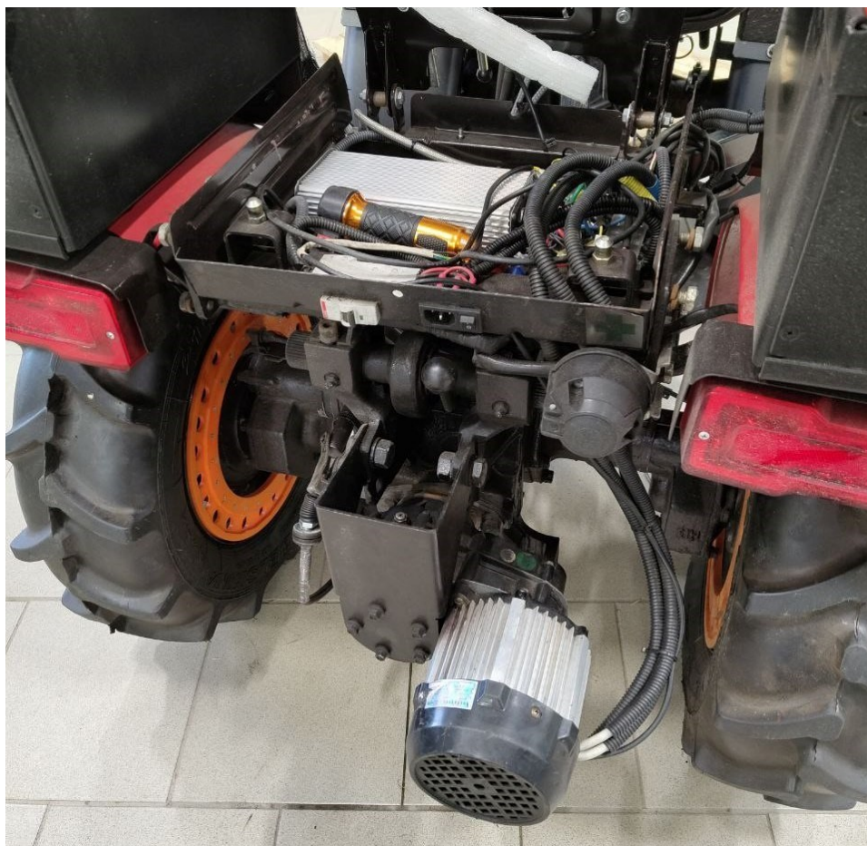
Рисунок 3.4 – Электродвигатель, установленный на задний ВОМ. Частотный преобразователь установлен под сидением.
