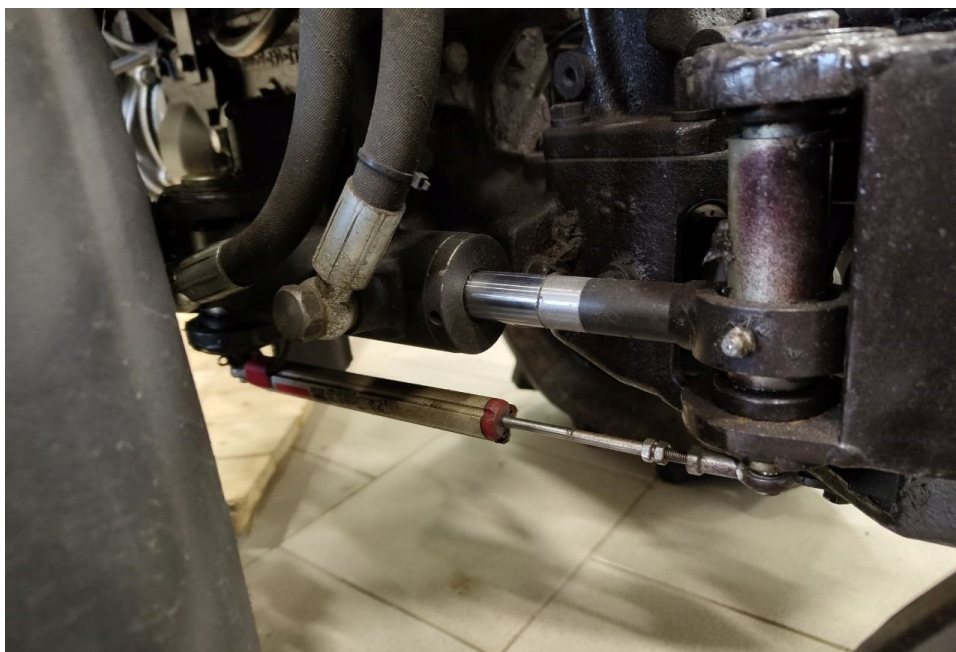
Рисунок 3.8 – Линейный потенциометр, установленный на шарнирно сочлененную раму для контроля угла поворота колес.
