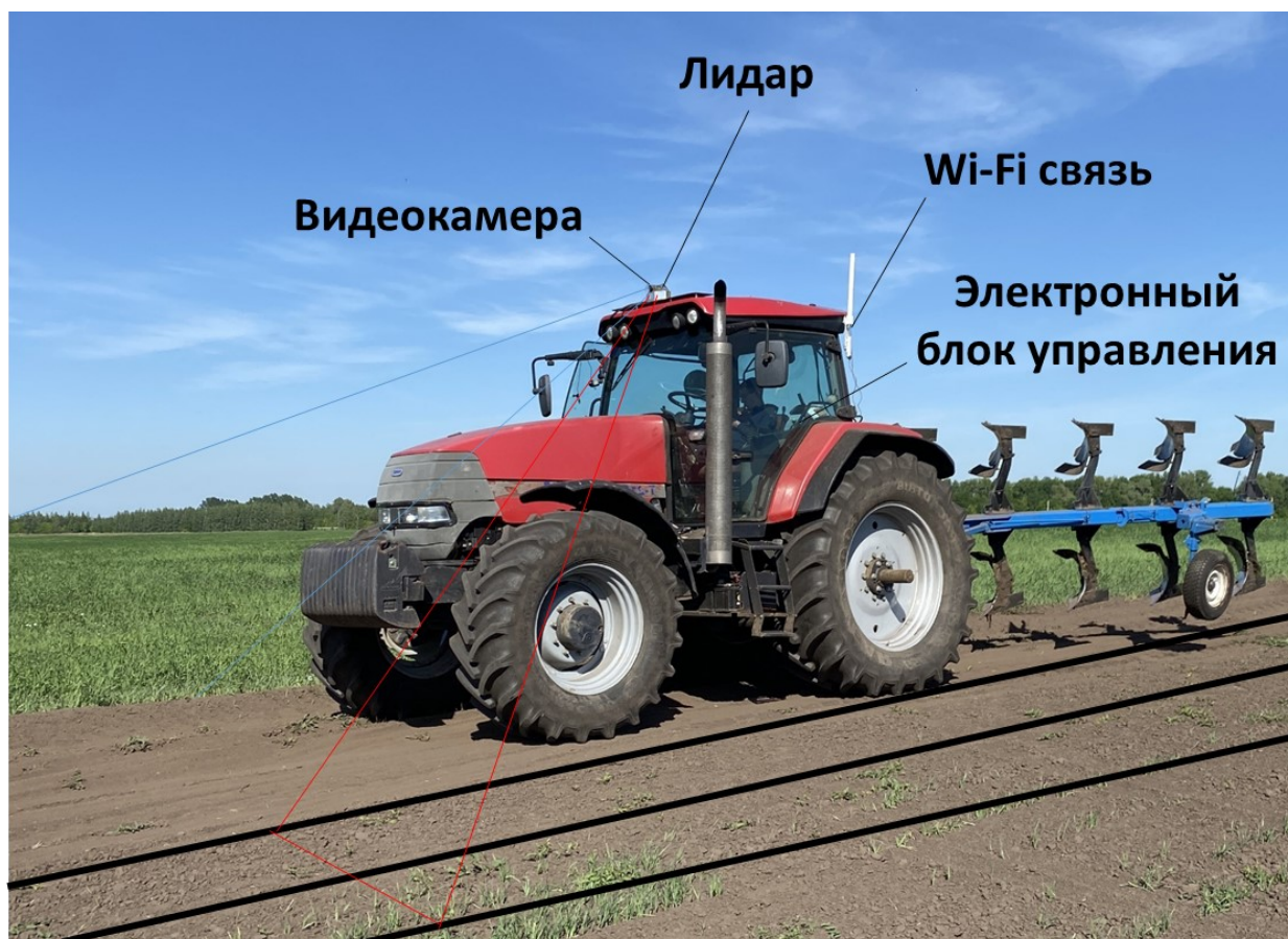
Рисунок 2.11 – подсистема машинного зрения ИС БСТС
