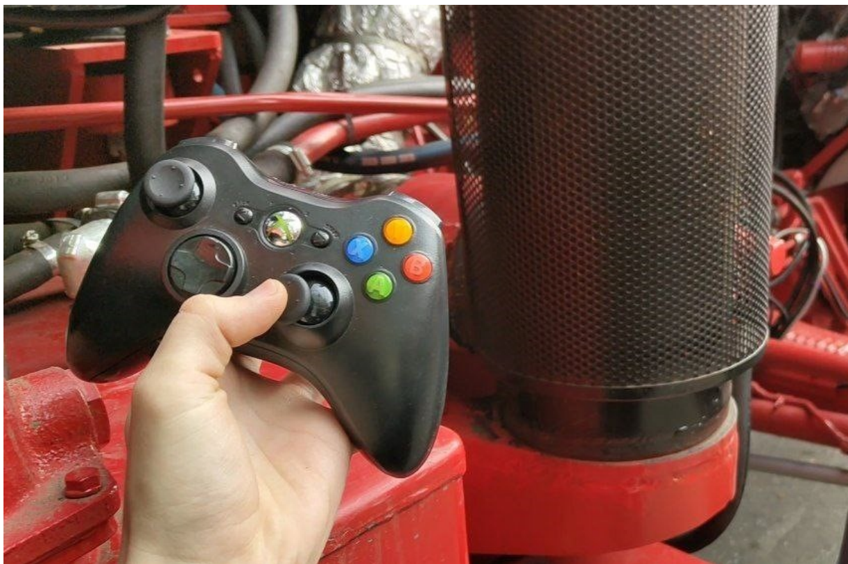
Рисунок 3.20 – Беспроводной контроллер, с помощью которого осуществляется управление трактором.
