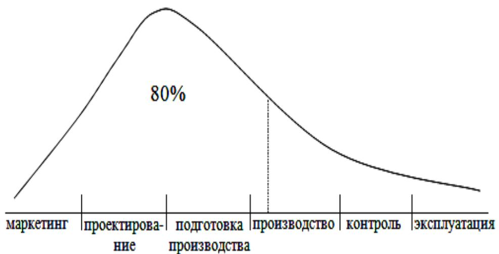
Рисунок 7 - Закон распределения ошибок на этапах жизненного цикла продукции среднего машиностроения
