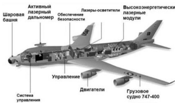
Рисунок 1 – Схема мобильного комплекса ABL, размещенного на борту самолета Boeing 747-400F
