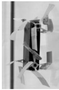
Рисунок – 7. Перемещение по стеклу (пленка Гекко нанопласт)
