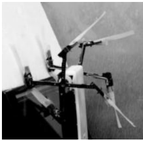
Рисунок 6 – Переход робота Mini-Wheegs от стекла к пластмассе
