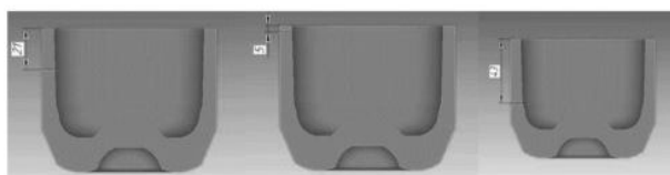
Рисунок 5 – Расположение расчетных сечений:: верхнее, среднее, нижнее
