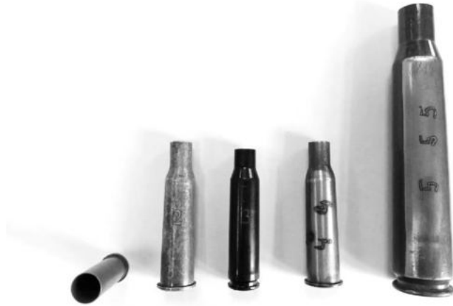
Рисунок 1 – Промаркированные гильзы с помощью лазера и «ручки»: а) пистолетная гильза (вид сверху и под микроскопом); б) винтовочные гильзы
