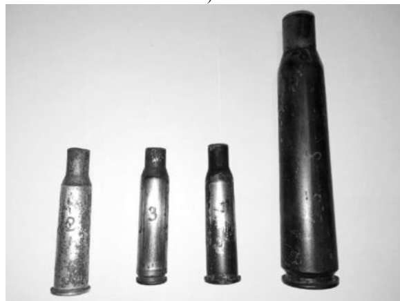
Рисунок 2 – Гильзы после проведения термообработки
