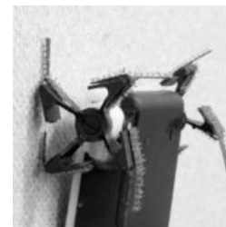
Рисунок 5 – Робот с липучкой на колесных опорах, взбирающийся по вертикальной тканевой поверхности
