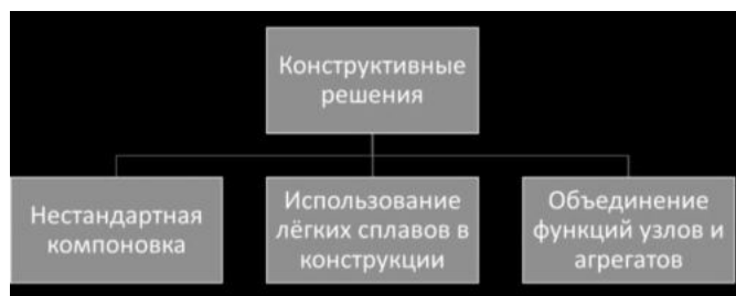
Рис. 1. Конструктивные решения для снижения массы ствольных орудий полевой артиллерии
