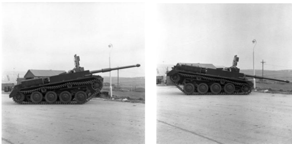
Рис. 8. САУ FV4401 при разных углах возвышения (склонения) орудия
