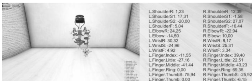
Рис. 7. Виртуальная модель ЗУКТ с отражением значений углов поворота кинематических звеньев
