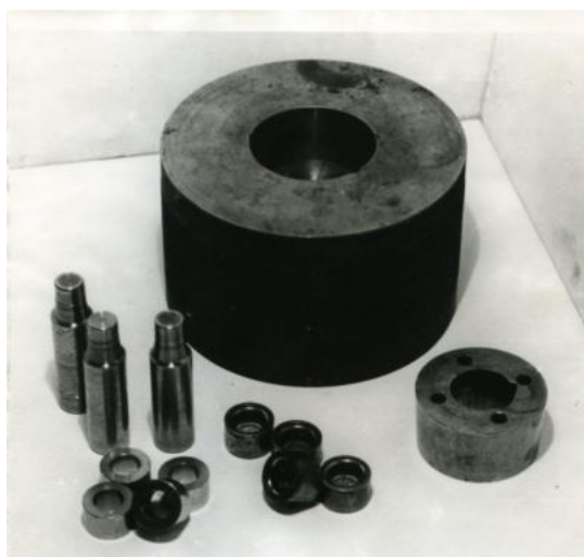
Рис. 2. Фотография штампа, заготовок, пуансонов и полуфабрикатов после выдавливания
