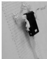
Рисунок 4 – Робот перемещающийся по пенополистиролу
