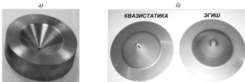
Рис. 2. Матрица и образцы после квазистатического и импульсного нагружения
