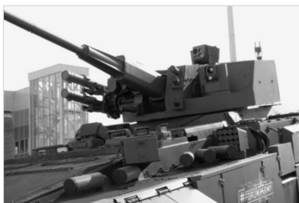
Рис. 2. Боевой модуль с 57 мм автоматической пушкой АУ-220М
