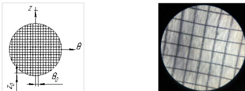
Рис. 6. Мембрана с нанесенной сеткой и ее изображение в микроскопе: z_0, \theta_0 – размеры ячеек в осевом и тангенциальном направлениях
