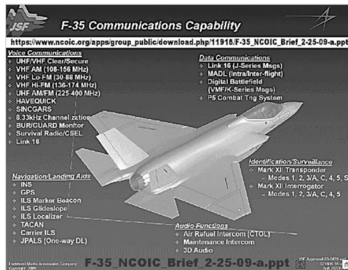
Рис. 3. Аппаратура навигации и связи самолета F-35. Характеризуется использованием широкого спектра изделий, работающих в разных диапазонах волн
