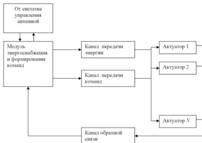
Рис. 1. Обобщенная структурная схема системы управления формой космической антенны с использованием оптико-электронных средств
