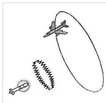
Рис. 6. Распространение ударной волны стержневой БЧ
