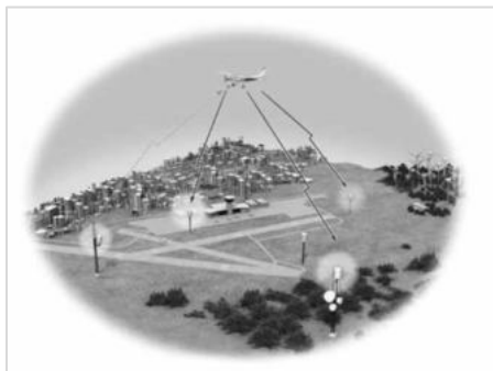
Рис. 1. Пример трехпозиционной АПМРЛС с всенаправленным передатчиком (слева) и тремя приемниками
