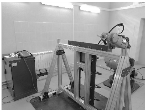
Рис. 2. Опытный участок инкрементальной штамповки
