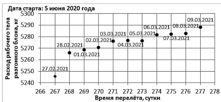
Рис. 4. График зависимости массы рабочего тела разгонного блока от времени перелёта
