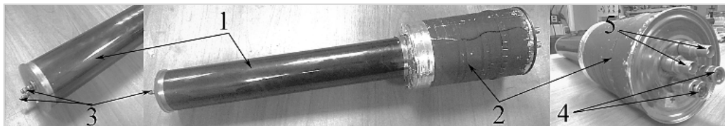
Рис.1. Прототип экспериментального расходомера
