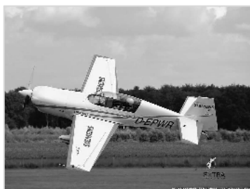
Рис. 3. Электрический самолёт Extra 330LE
