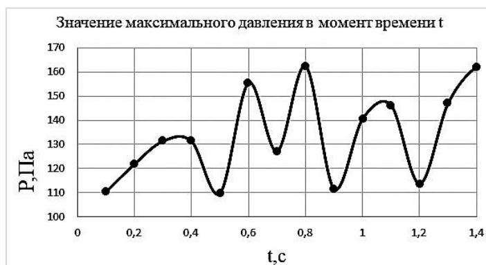
Рис. 6. График зависимости максимального давления, действующего на профиль, от времени
