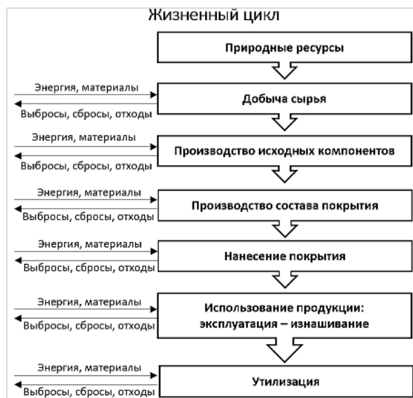
Рис. 2. Схема жизненного цикла функциональных покрытий
