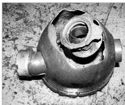
Рис. 3. Разрушение головки жаровой трубы КС
