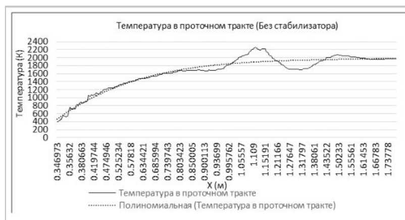
Рис. 13. График температуры от расстояния (без стабилизатора)
