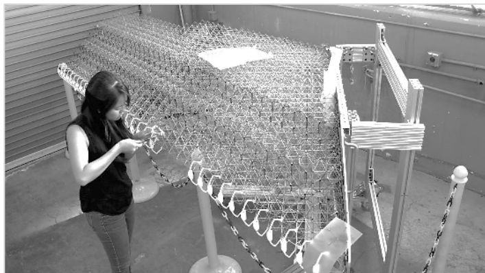
Рис. 2. Сборка крыла NASA из вокселей
