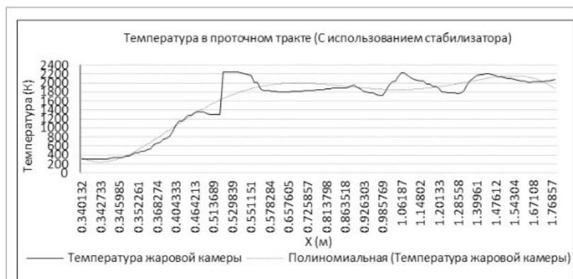
Рис. 12. График температуры от расстояния (со стабилизатором)
