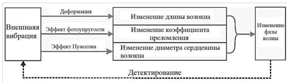
Рис. 1. Схема изменения фазы излучения в оптическом волокне при внешнем воздействии
