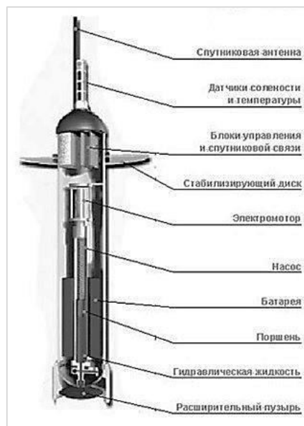
Рис. 3. Схема устройства дрейфующего буя «ARGO»
