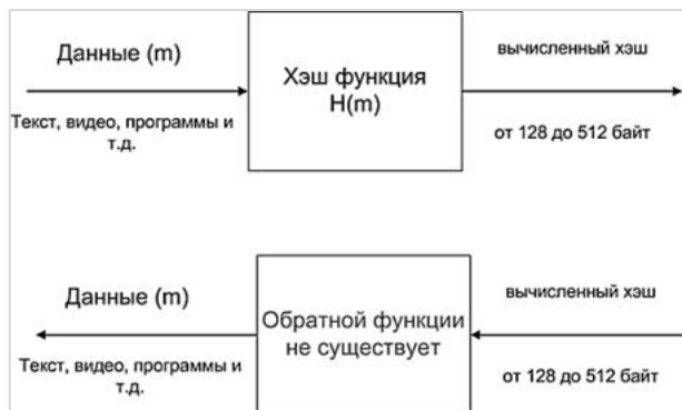
Рис. 1. Принцип работы односторонней хэш функции
