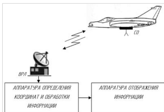
Рис. 1. Принцип работы СВРЛ
