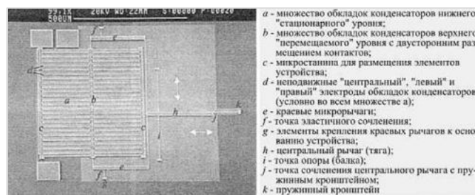
Рис. 10. Внешний вид микро-рычага и иллюстрация принципа его действия
